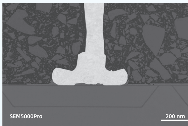
使用插入式背散射电子探测器（BSED）对芯片上金线焊点成像。前处理：离子束抛光。
