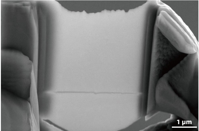
铁素体马氏体钢（微磁）DB500电子像
