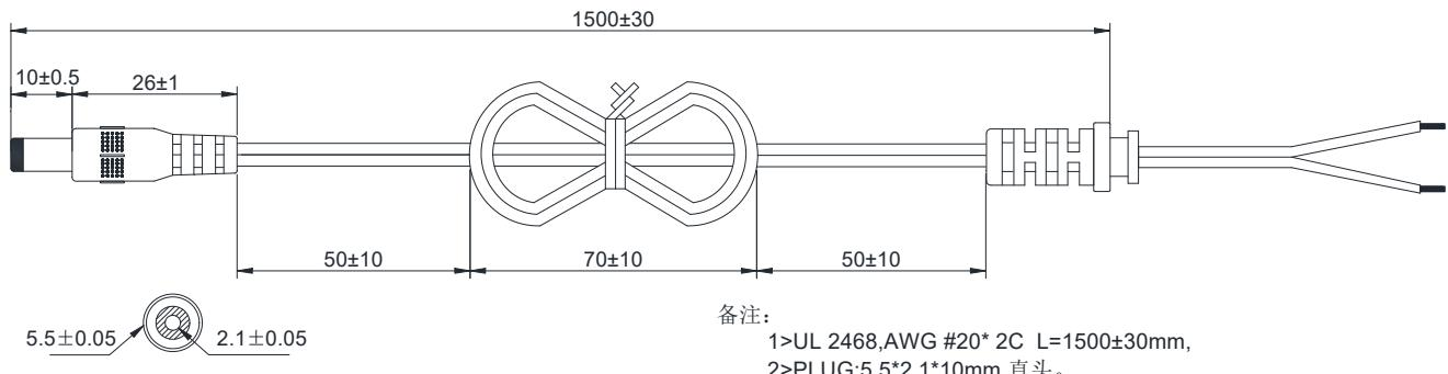
**8、APPEARANCE DRAWING:(Unit:mm) 产品外观图:(单位:mm)**
