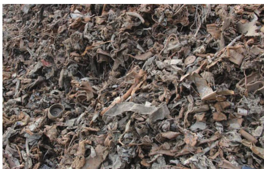
图 A.7 破碎型再生钢铁原料 SRS401/402
