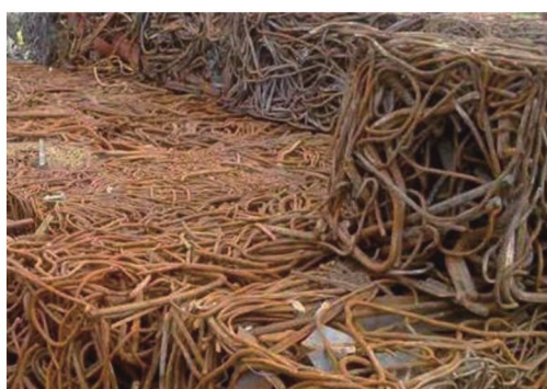
图 A.8 破碎型再生钢铁原料 SRS 403
