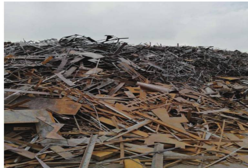
图 A.2 重型再生钢铁原料 HRS102
