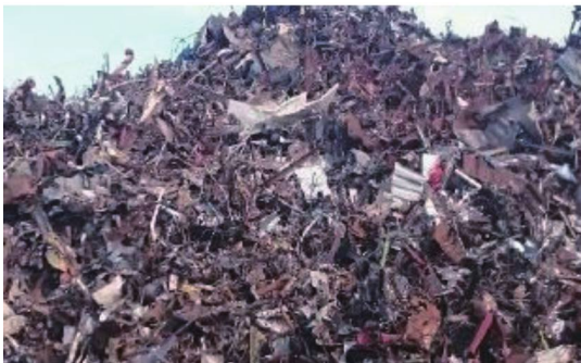
图 A.5 小型再生钢铁原料 LRS301
