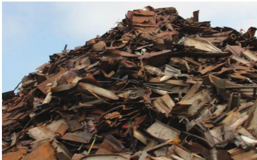
图 A.1 重型再生钢铁原料 HRS101
