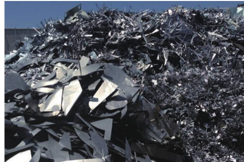
图 A.6 小型再生钢铁原料 LRS303
