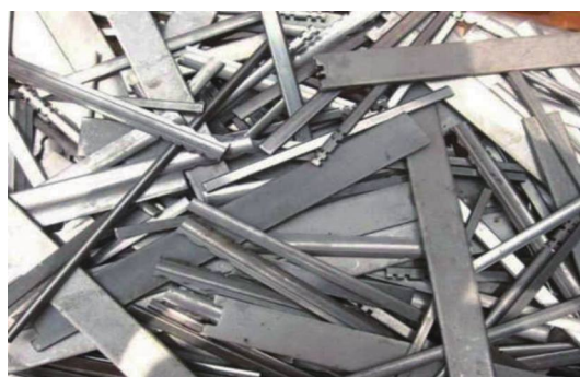
图 A.9 包块型再生钢铁原料 BRS501
