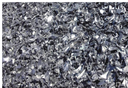
图 A.8 破碎型再生钢铁原料 SRS 403
