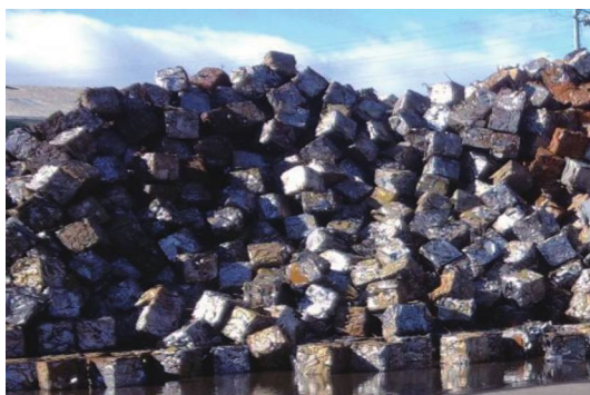
图 A.7 破碎型再生钢铁原料 SRS401/402
