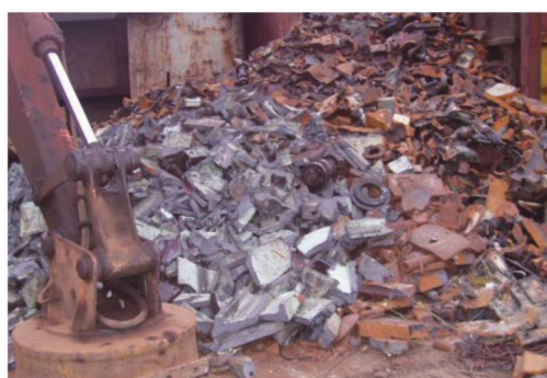
图 A.10 包块型再生钢铁原料 BRS502
