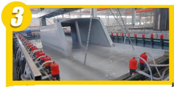
3 顶尖涂装工艺, 上装电泳选择, 防腐防锈十年无忧
