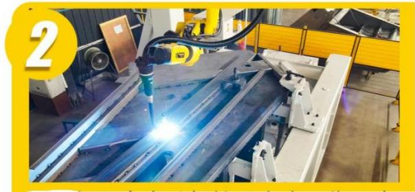
2 智能机器人自动焊接, 安全可靠、密封性好
