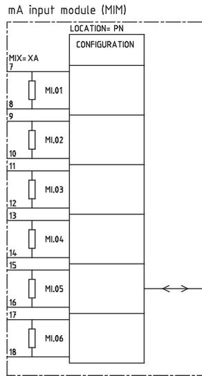
Figure 12. mA input module (MIM)
