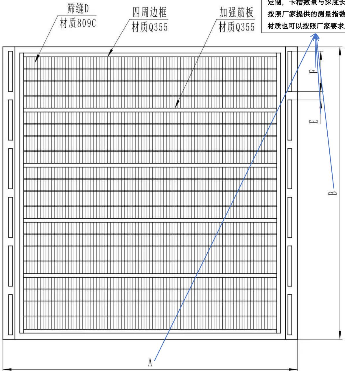
聚氨酯包边不锈钢条缝筛板
