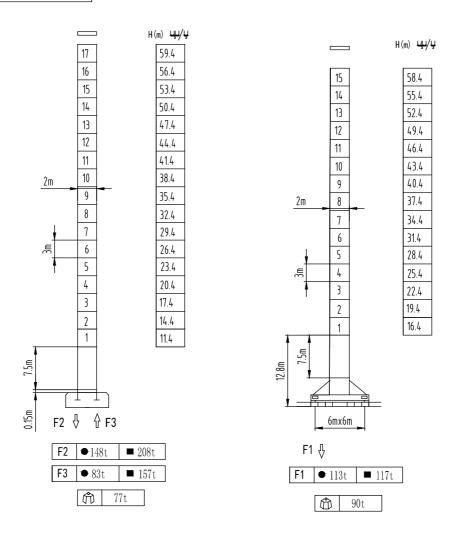
固定式附着高度 Anchoring height of stationary crane
