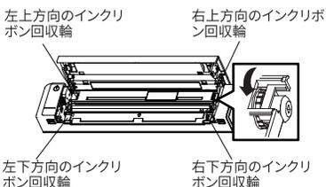
4. 両手でカバーの左右両端を同時に下向いて「ガチッ」と音がするまで押し込んでください。
