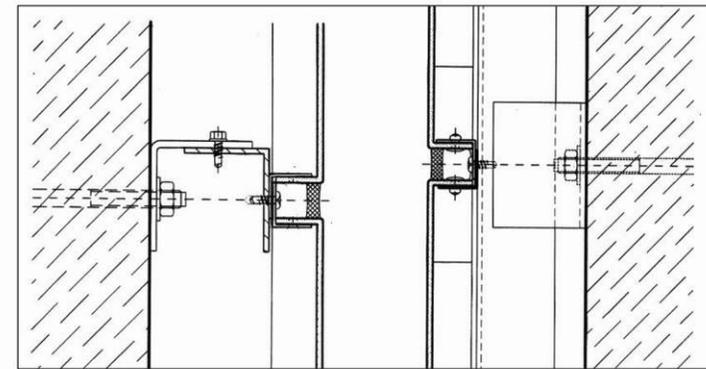
幕墙板安装示意图
