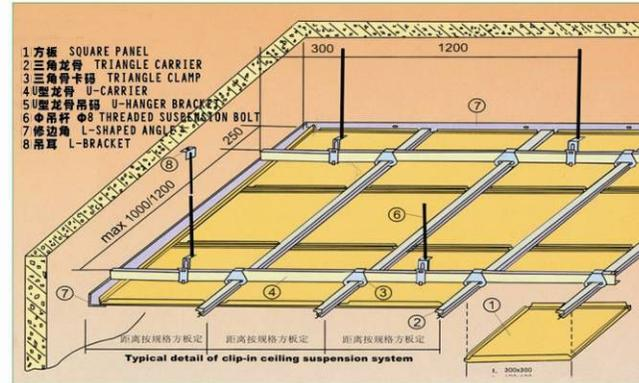
安装次序: (1) 先吊好轻钢龙骨, 拉好水平线。 (2) 将专用三角卡码扣入三角龙骨, 按所安装方板规格规格卡上(三角龙骨只需单向使用), 见图。 (3) 将龙骨安装好后, 直接将方型扣板压入三角骨缝中, 稍加轻压就可以了。
