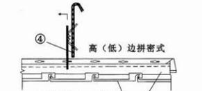
A型弹簧吊码安装法 ASPRING HOLDDOWN INSTALLATION 2
