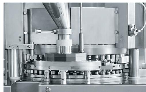
强迫加料装置控制药粉流动和填充，确保加料精度；加料器易拆装，平台易调整；压片室无死角结构，便于观察，清洁。
