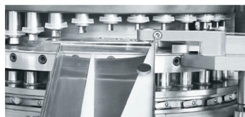
符合GMP要求，能压制双层双色片、环形片、圆形片、刻字片和异形片，适合于制药、食品、化工等行业的高效、精密压片。
