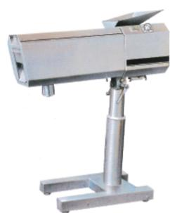
HRD-100型高速筛片机应用压缩空气吹扫，离心除粉，滚筒磨边及真空吸尘原理，清除附着在片子表面的粉末及边缘毛边，使片子表面清洁，边缘整齐。用于压片机压出的圆片、异形片特别是大片径片子、刻字片的高速、高效除粉，可与任何类型的中、高速压片机连机使用。
