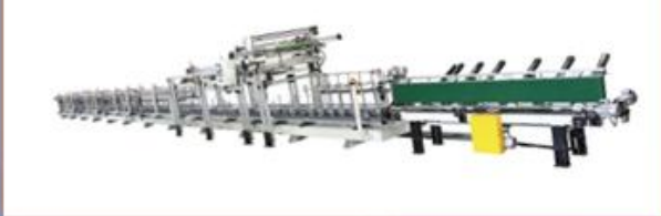
HY-FE-1300W PUR胶360°绕板包覆机 PUR glue panel wrapping machine
