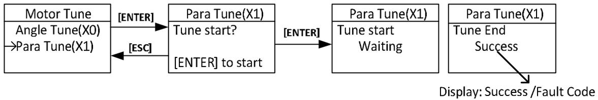
FIGURE 7.2 MOTOR PARAMETER TUNING WORKFLOW
