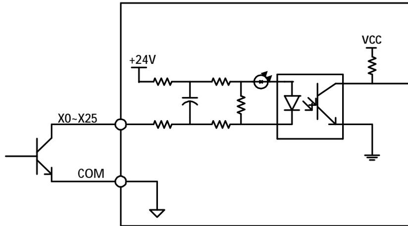
FIGURE 3.5 COMMON EMITTER INPUT
