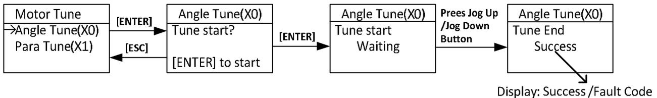
FIGURE 7.4 MOTOR INITIAL ANGLE STATIC TUNING
