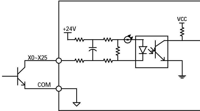
FIGURE 3.5 COMMON EMITTER INPUT
