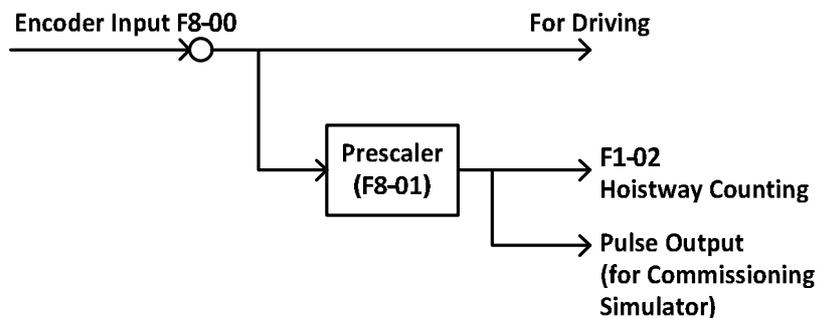
FIGURE 6.15 ENCODER PULSE USAGES
