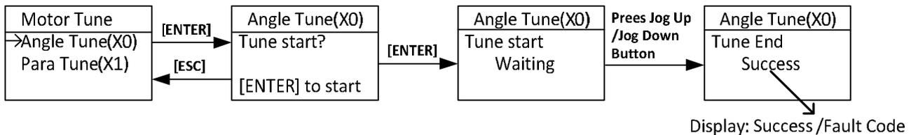
FIGURE 7.4 MOTOR INITIAL ANGLE STATIC TUNING
