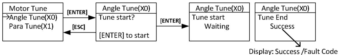
FIGURE 7.3 MOTOR INITIAL ANGLE ROTATION TUNING
